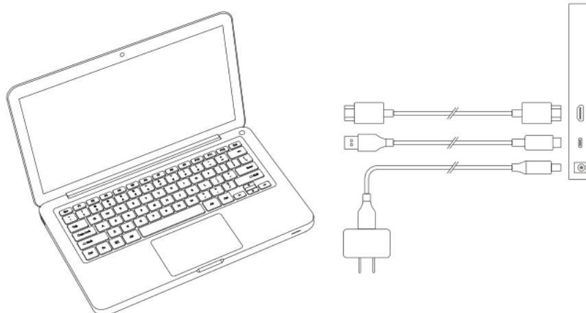
2. USB-C連接(適用於全功能USB-C接口): 用USB-C線將數位屏連接到您電腦的USB-C接口。再將電源接口連接至牆壁插座的變壓器。
